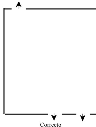
Si las dos salidas están demasiado juntas, puede admitirse como solución para evitar el bloqueo simultáneo por el humo la separación con un elemento que garantice una resistencia al fuego de RF-30 (Por ejemplo, un tabique de ladrillo. No podría aceptarse una mampara de madera y vidrio). La longitud mínima de este elemento no viene determinada por la Norma por lo que corresponde al supervisor establecerla en función de las características constructivas del lugar inspeccionado (CPI-7.2.3.b)
